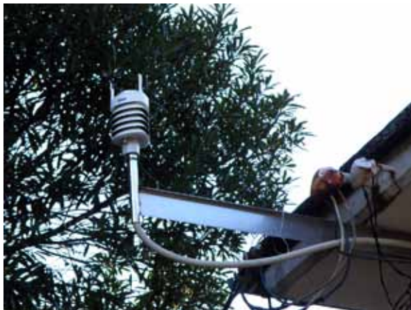
デジタル百葉箱 (ネットワーク対応気象観測装置) (廿日市市宮島町三ツ丸子山, 2010年1月29日, 向井撮影)
